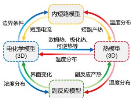
图3 三维电化学-热-内短路模型的耦合方式
